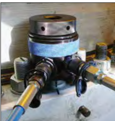
▼ Tendeur de la série GT pour le serrage des pales d'une éolienne.
