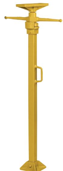
3.4. Les outils de soutènement de série RS (image de droite) sont également utilisés pour soutenir des charges. Leur structure robuste permet de supporter jusqu'à 3,6 tonnes sans risque de fluage. Ces soutènements sont couramment utilisés dans des applications minières.
