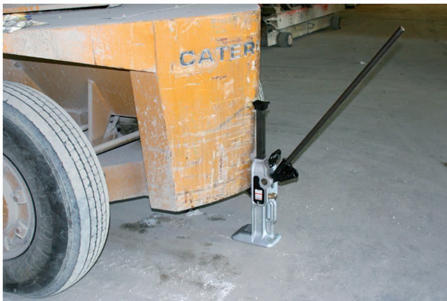
Un RJA1022 utilisé pour soulever un chariot élévateur afin d'effectuer une réparation de pneu
