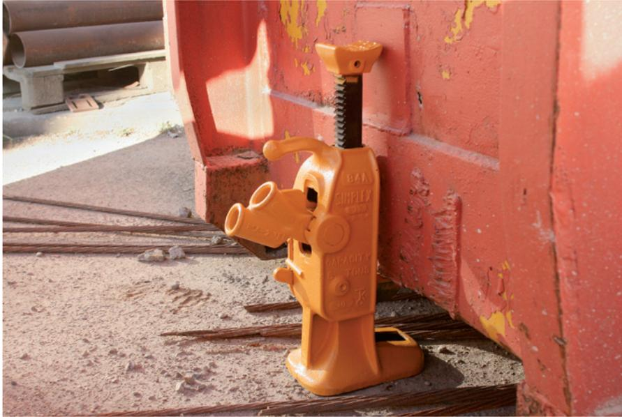
Un RJ84A utilisé pour soulever un conteneur en acier
