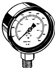
Tous les systèmes hydrauliques devraient être équipés d'un manomètre. Le manomètre est la fenêtre du système hydraulique. Le manomètre indique non seulement la pression de travail, mais il peut également signaler une anomalie dans le fonctionnement de l'installation.
