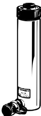
La tête de la tige du piston possède deux fonctions importantes. Elle protège le filetage de la tige et empêche la déformation de l'extrémité de celle-ci. Maintenez la tête de la tige constamment en place. Ne pas utiliser de pièces d'adaptation vissées dans la tige du piston pour supporter une charge. La charge doit être supportée par la surface de la tige. Le filet se trouvant dans la tige pourrait être arraché lors de l'application de la charge.
