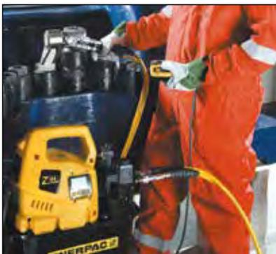
◀ Toute marque de clé dynamométrique peut fonctionner avec la pompe portable pour clé dynamométrique série ZU4T.
